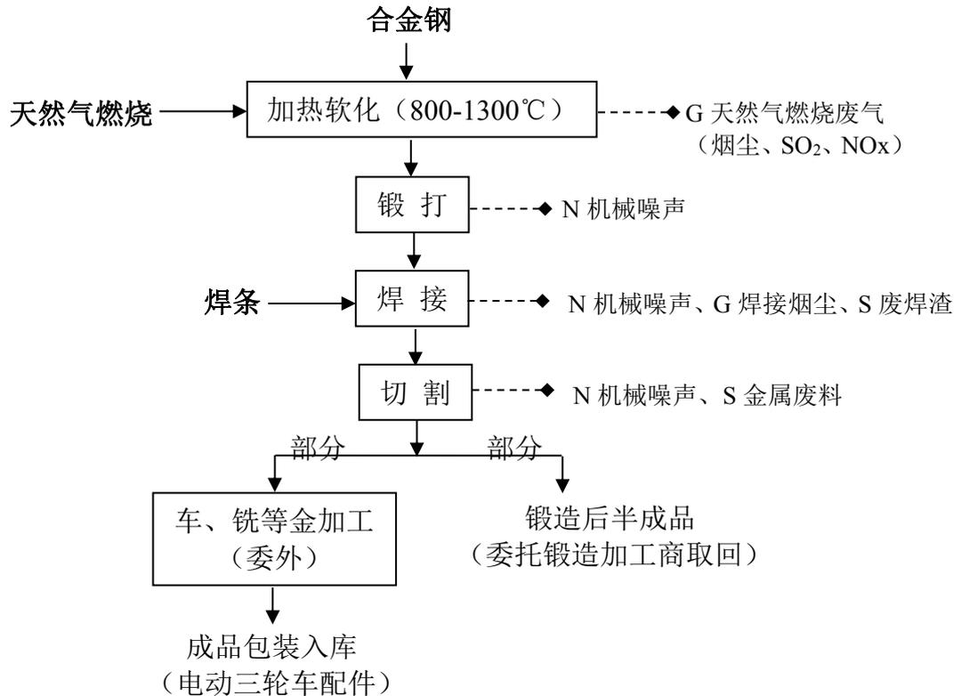
图 2.2-1 本项目生产工艺流程框图及主要产污环节图
