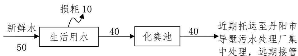
图 2.2-2 本项目用水排水平衡图 (t/a)
