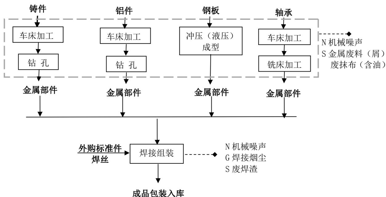
图 2.2-1 本项目生产工艺流程及产污环节框图
