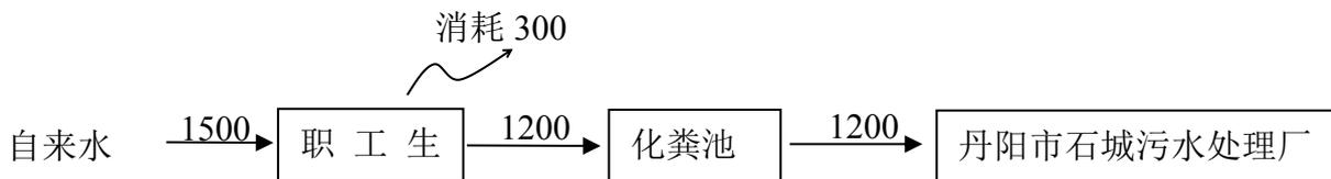
图 3 项目水量平衡图（单位  $\text{m}^3/\text{a}$ ）
