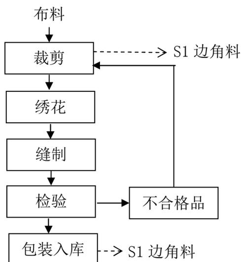
图 2.2-2 本项目件套产品生产工艺流程框图及主要产污环节图
