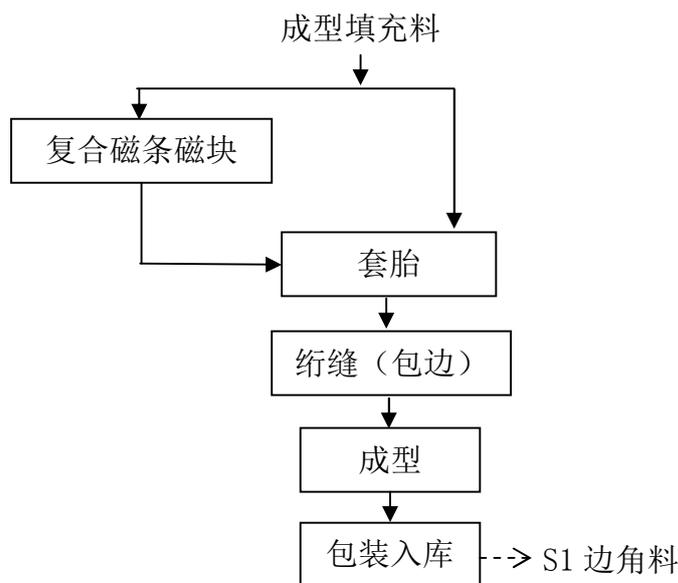
图 2.2-3 本项目床垫产品生产工艺流程框图及主要产污环节图
