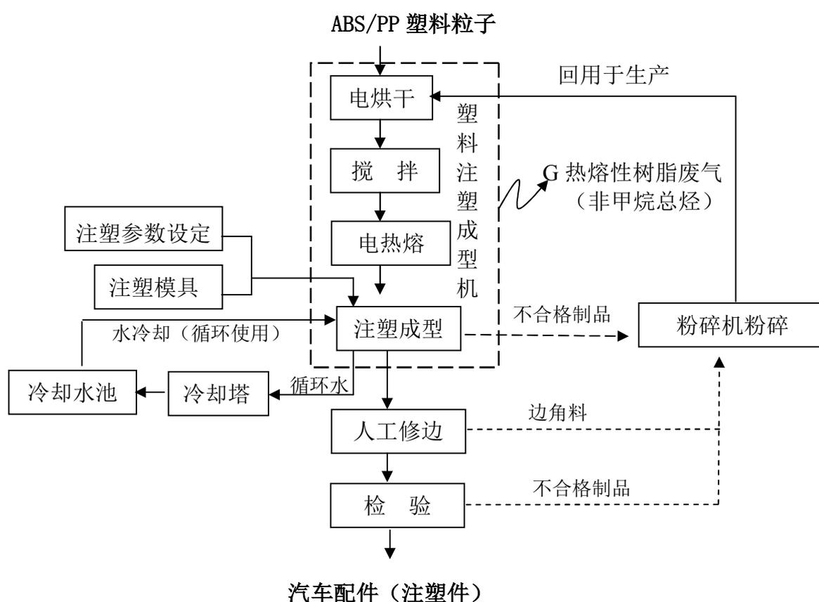
图 1 汽车配件（注塑件）生产工艺及产污环节示意图
