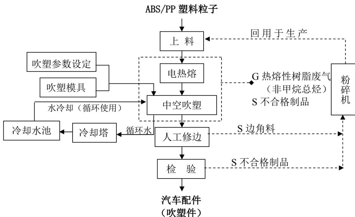
图2 汽车配件（吹塑件）生产工艺及产污环节示意图
