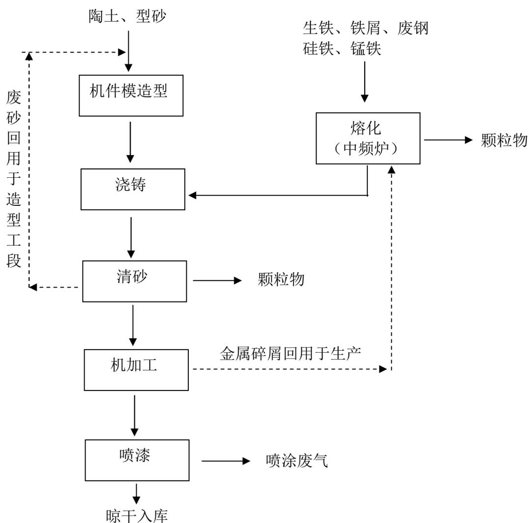
泵、阀门生产工艺流程简述如下：
