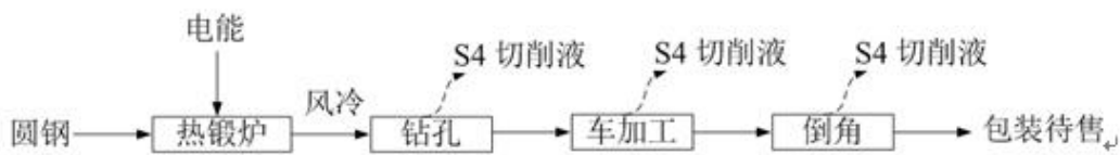
图 2.2-2 本项目双质量飞轮生产工艺流程框图及主要产污环节图
